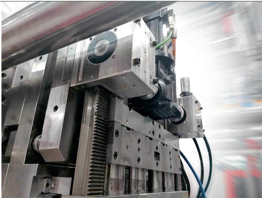
**Verlässlich:** Bei Fischer stellen lifgo-Zahnstangengetriebe sicher, dass die Rohlinge der Klebstoffkartuschen gleichmäßig und mit großer Kraft von den Formkernen des Spritzgießwerkzeugs abgestreift werden
